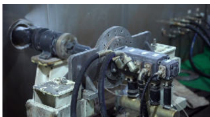
Насос рабочей жидкости гидросистемы Испытания при -40 °C
