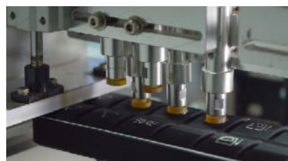
Кнопки панели 1,2 млн циклов теста на надежность
