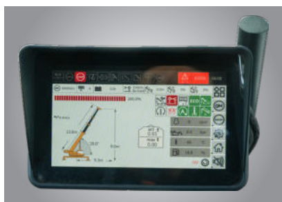
Система ограничителя грузового момента нового поколения с высокой точностью
